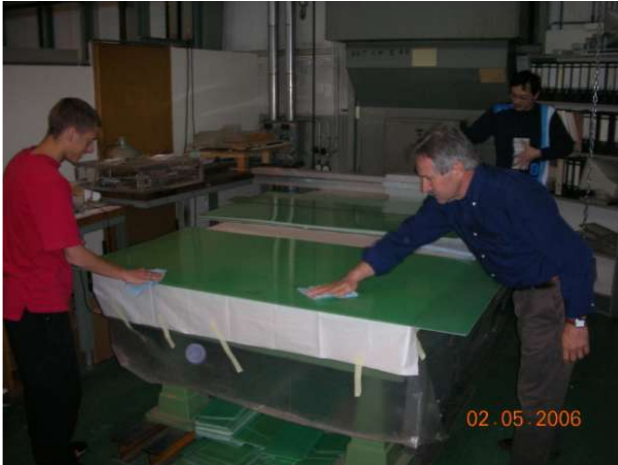
Lucidatura pannello di vetronite
