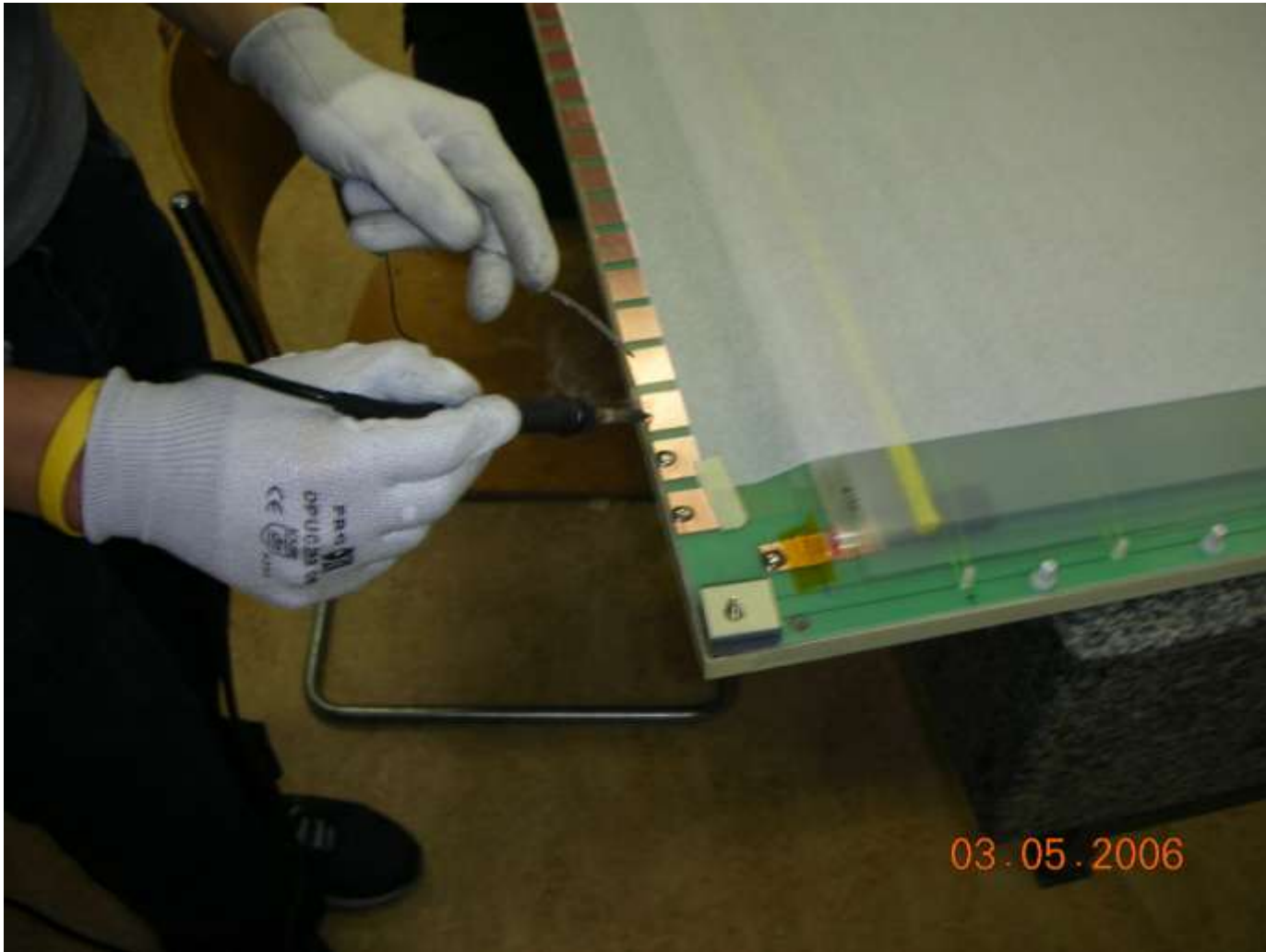
Fase di saldatura dei contatti per mezzo di saldatore a stagno
