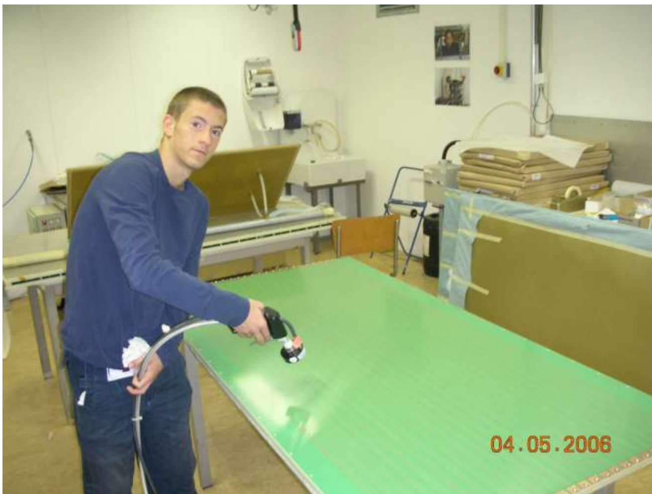
Trattamento del pannello tramite argon
