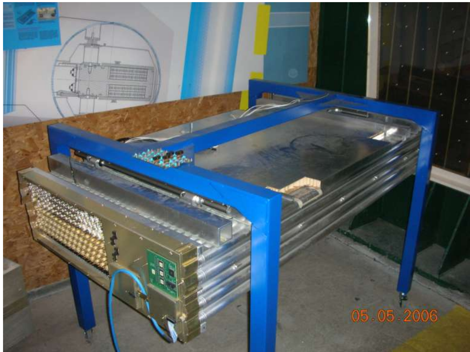
Camera rivelatrice di particelle simile al MRPC
