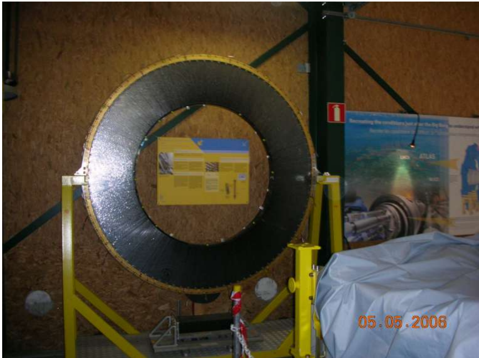
Rivelatore a tubicini per individuare la posizione delle particelle prodotte dalla collisione
